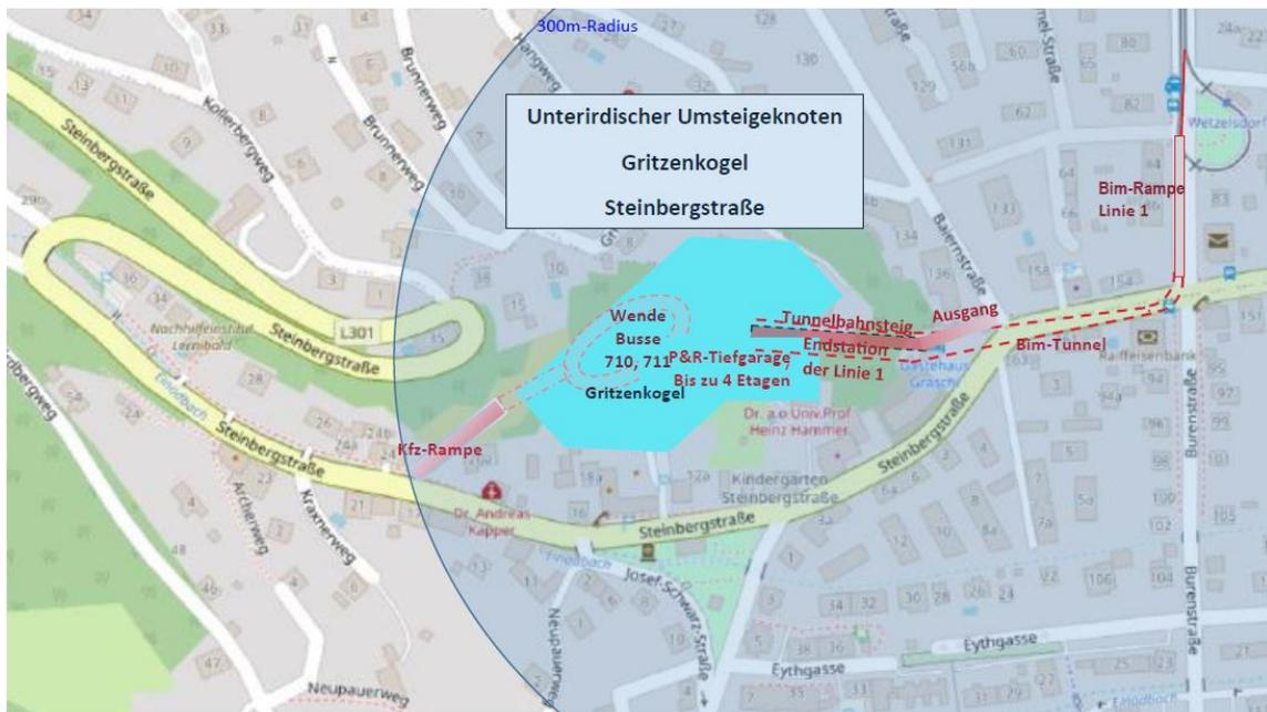
Anmerkung: Vor einer Realisierungsinangriffnahme insbesondere der Tiefgarage und der Bus-Wende sind jedenfalls die statischen Voraussetzungen zu überprüfen!!! Eine Verlängerung der Bim von der Burenstraße in den Gritzenkogel ist nur im Zusammenhang mit der P&R-Anlage zu empfehlen.
