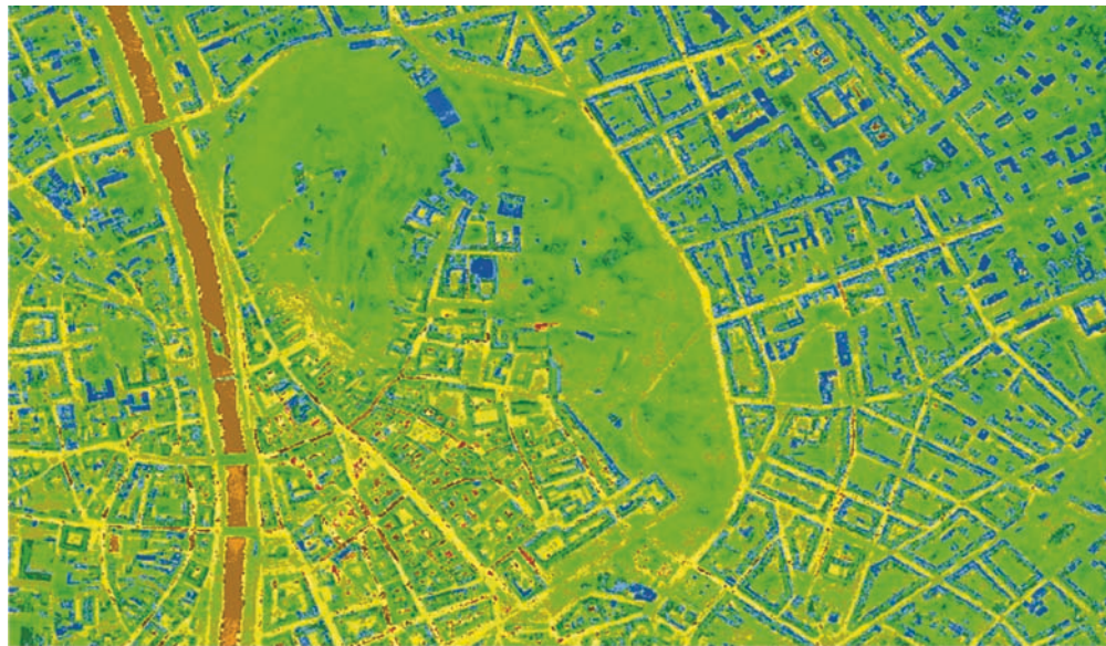
Abbildung 48: Strahlungstemperaturkarte – der Stadtpark und der Schlossberg im Vergleich zu den umliegenden Gebieten
